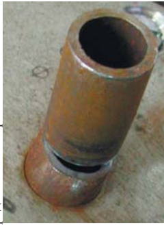
Рис 7. Фотографія відрізаної заготовки із сталі 20
