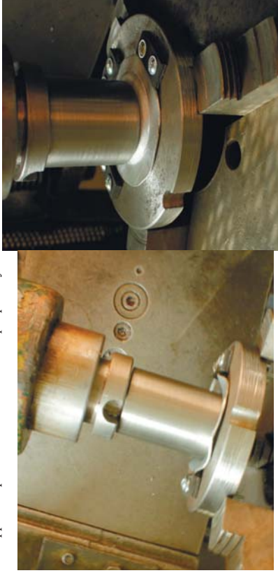
Рис. 2 – Витягування заготовки з фланцевою частиною: а) – перший перехід з отриманням гофрів; б) другий перехід з кантуванням заготовки на 180°
