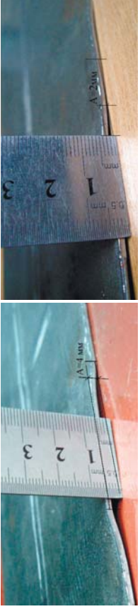
Рис. 3. Изменение амплитуды волнистости на краяхках полосы: а – исходная волнистость; б – после 3 прохода
