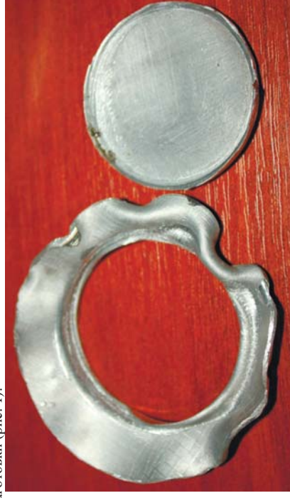
Рис. 1 – Відривання донної частини заготовки з алюмінію ( s=1,4 мм, m=0,7 )
