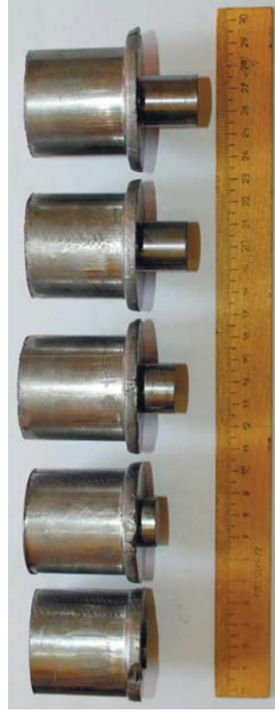
Рис. 4 – Детали, полученные комбинированным трёхсторонним выдавливанием
